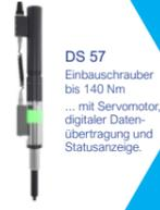
DS 57 Einbauschrauber bis 140 Nm ... mit Servomotor, digitaler Datenübertragung und Statusanzeige.
